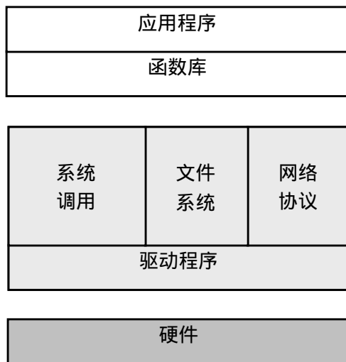
图 2-1 嵌入式 Linux 系统的组成
